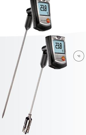
O testo 905-T1 é um termómetro de penetração particularmente rápido com uma ampla gama de medição de -50 a +350 °C, por curtos períodos até 500 °C (1 a 2 minutos). O instrumento de medição tem um sensor industrial profissional (termopar Tipo K). Ele tem um excelente nível de exatidão, especialmente na gama de medição superior.
