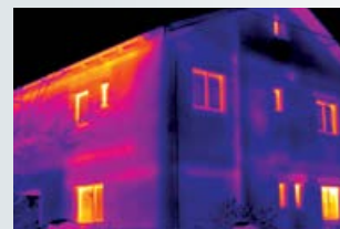
Deteção das perdas de energia em edifícios: Detecção e ilustração imediatas de pontes térmicas em fachadas ou no edifício.
